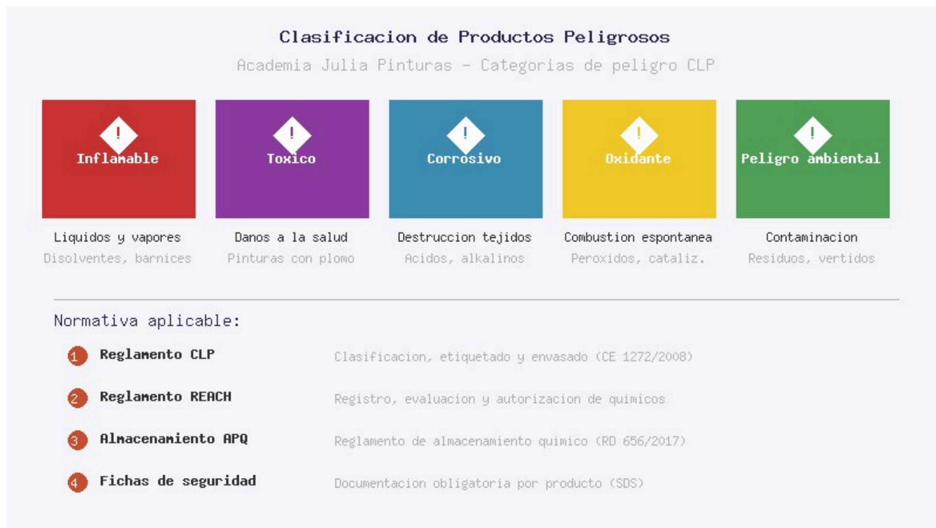
Figura 1: Clasificación de productos peligrosos según el reglamento CLP. Las cinco categorías principales (inflamable, tóxico, corrosivo, oxidante y peligro ambiental) determinan las condiciones de almacenamiento y los EPIs requeridos para cada tipo de producto.
